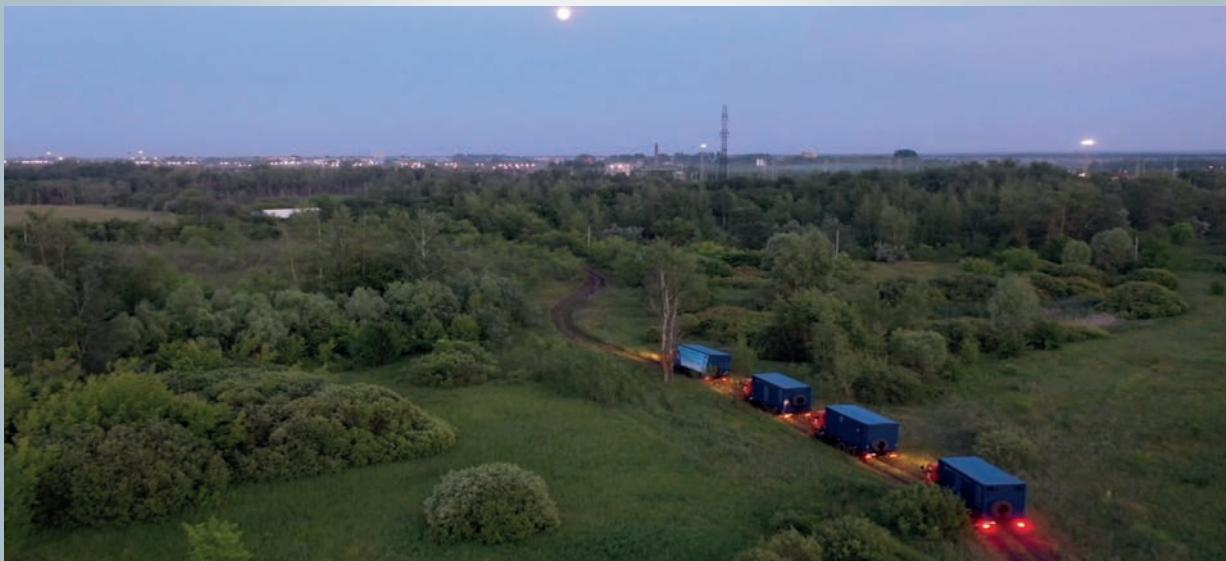
**Энергопоезд – это три дизельных генератора и одна подстанция, установленные на шасси автомобилей КАМАЗ высокой проходимости.**
